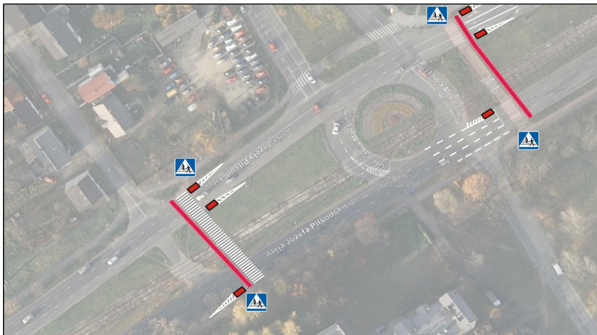
Rys. 3.3.14. Propozycja zmian w organizacji ruchu w lokacji 7 – skrzyżowanie Alei Marszałka Józefa Piłsudskiego z ul. Leona Kuczkowskiego w przypadku utrzymania obecnej klasy drogi – budowa azyli (opracowanie własne – mapa http://msippub.dabrowa-gornicza.pl/msip ).
