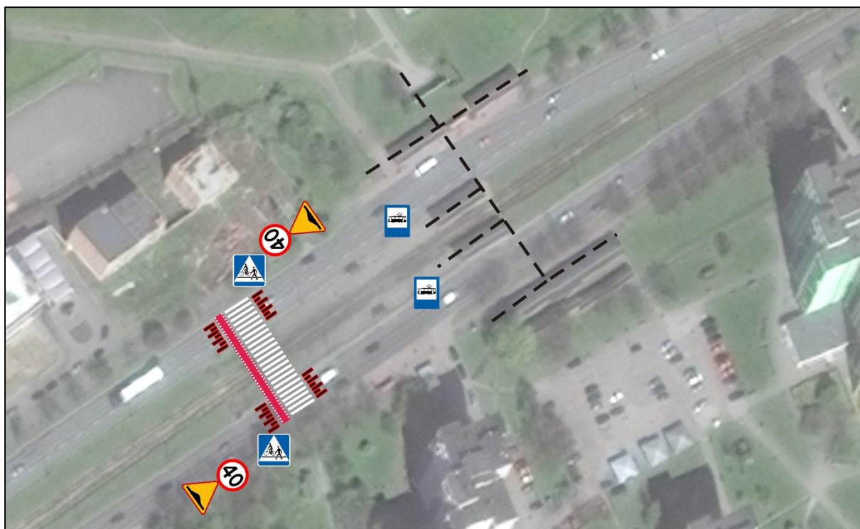
Rys. 3.3.17. Propozycja zmian w organizacji ruchu w lokacji 8 - przystanek Gołonóg Manhattan w przypadku obniżenia klasy drogi do co najwyżej klasy Z – budowa wyniesionych przejść/przejazdów (opracowanie własne – mapa http://osmapa.pl/ ).
